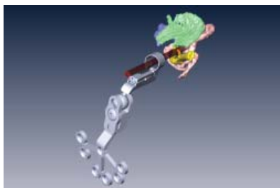
Ein aktuelles Forschungsprojekt der HNO-Klinik: Das implantierbare Hörgerät «DACS» der Lage des Schallwandlers (rot) in der Halterung (grau)
